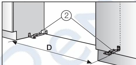
Расстояние "D" между устройствами защиты от опрокидывания ② точно соответствует ширине прибора.
